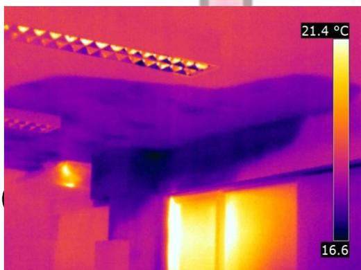
Sin ni siquiera tener que medir temperaturas, una imagen térmica puede desvelar zonas que, aun con poquísima diferencia de temperatura, están en un estado energético distinto debido a su contenido en agua, pudiendo apreciar la extensión total de los daños por humedades.
